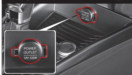
Presa di corrente per il modello senza caricabatterie wireless (lato anteriore della console centrale)
